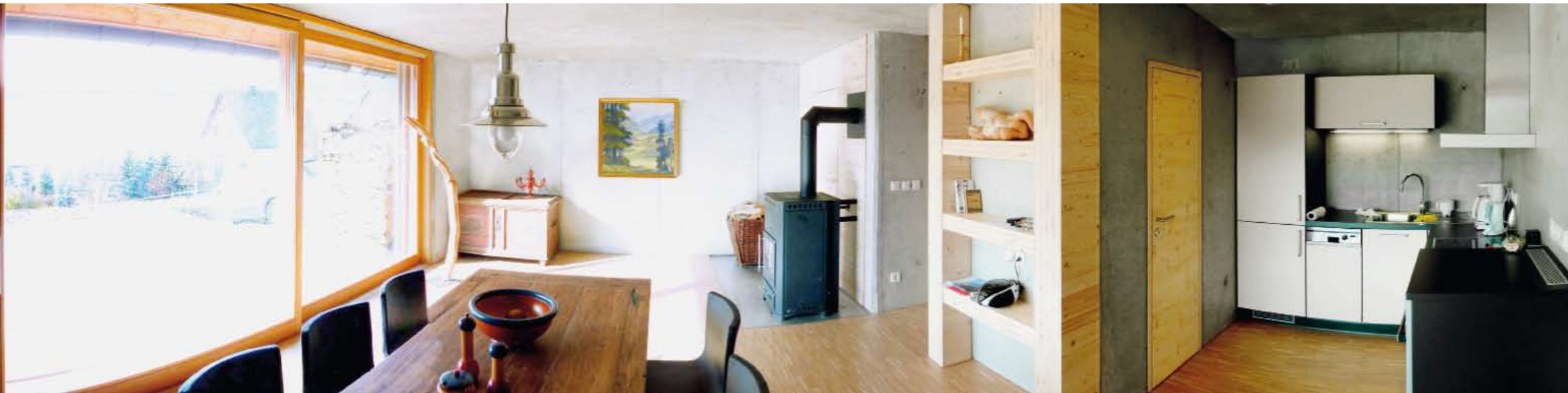
Die Architektur des Gebäudes ist so ausgelegt, dass die großen Glasflächen vor allem in den strengen Wintermonaten jede Menge Sonnenenergie einfangen. Im Bild ist der Kaminofen zu sehen, der bei Bedarf zugeschaltet werden kann.
