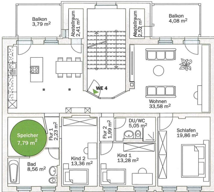
Grundriss einer modernisierten Wohnung: links die Anordnung des Langzeit-Wärmespeichers mit einem Durchmesser von 2,50 m.
