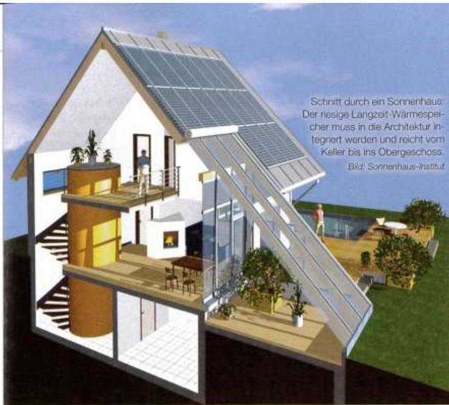
Schnitt durch ein Sonnenhaus: Der riesige Langzeit-Wärmespeicher muss in die Architektur integriert werden und reicht vom Keller bis ins Obergeschoss.
