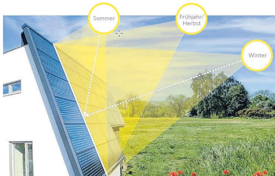
Die starke Dachneigung der „Aktivsonnenhäuser“ führen dazu, dass die Sonne auch im Winter relativ steil auf das Dach fällt.
